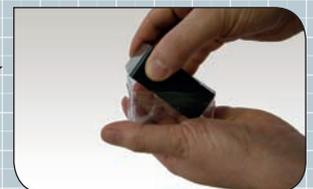
Vollständige Vernetzung des Produkts abwarten (unter 8 Min. bei +30°C) bevor der Druck abgenommen wird.
