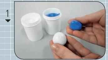
aus den beiden 2 Dosen die gleiche Menge des Produkts entnehmen.
