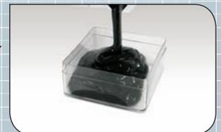
Innerhalb max. 1 Minute das Produkt im Inneren des Abdrucks auftragen.
