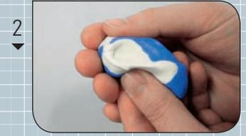
die beiden Komponenten max. 2 Minuten mischen bis eine gleichmäßige Farbe entsteht.
