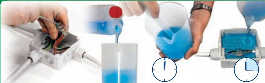
O isolante Magic Power fornecido no recipiente bi-componente pode ser usado, observando a relação 1:1, simplesmente despejando-o, após a mistura, na caixa fornecida no kit para proteger e vedar as conexões internas. O processo de reticulação do gel necessita de apenas e aproximadamente 15 minutos, enquanto que a caixa pode ser imediatamente alimentada.
