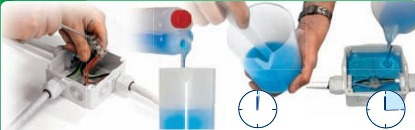
Se puede utilizar el aislante Magic Power suministrado en la botella bi-componente, en una proporción 1:1, simplemente vertiendolo, después de haber realizado la mezcla, en la caja entregada en el kit, para proteger y sellar las conexiones en el interior. El gel tarda solamente unos 15 min en reticular, pero la caja puede ser inmediatamente alimentada.
