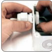
Instalar los sujeta cables.
