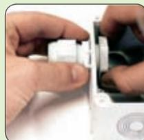
Instalar los sujetadores de cables.
