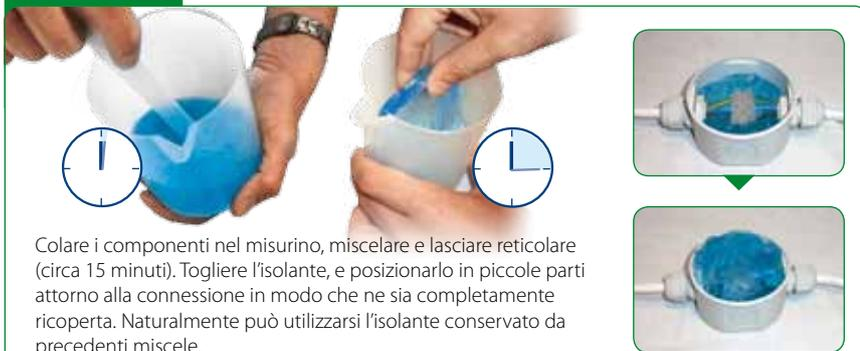
Colare i componenti nel misurino, miscelare e lasciare reticolare (circa 15 minuti). Togliere l'isolante, e posizionarlo in piccole parti attorno alla connessione in modo che ne sia completamente ricoperta. Naturalmente può utilizzarsi l'isolante conservato da precedenti miscele.
